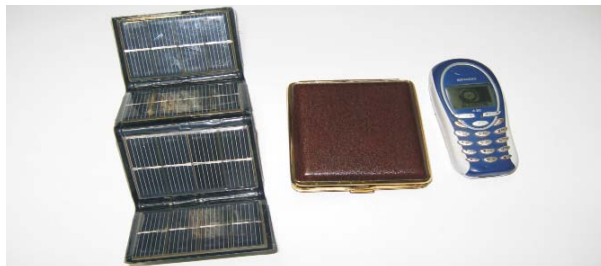
Рис. 2. Розкладна сонячна батарея для мобільних телефонів СБМТ-С-8.0-0.23 (експериментальний зразок). Праворуч від батареї лежить її футляр
