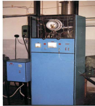
Рис. 1. Загальний вигляд макету дослідно-промислової установки розділення біогазу
