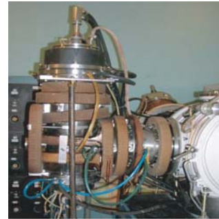
Рис. 1. Вакуумно-дугове джерело плазми з Т-подібним фільтром для осадження алмазо-подібних покриттів. Швидкість осадження покриття становить 6 мкм/год на площу діаметром 20 см
