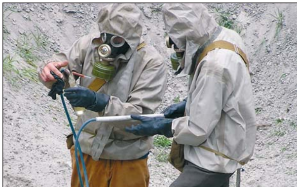
Оцінка ураження після використання технології відкритого спалювання відкритої детонації (ВСВД) для знищення мін типу ПФМ-1.
